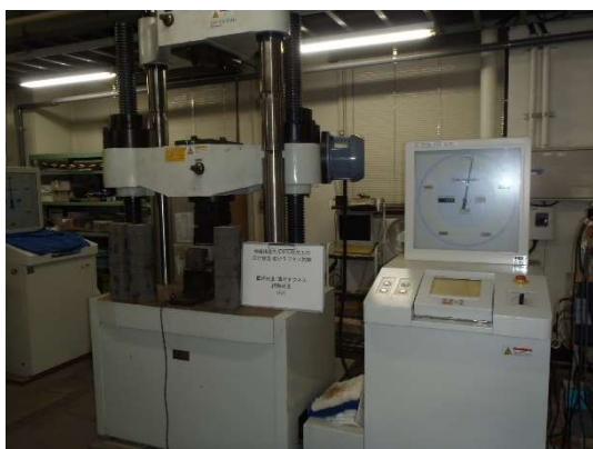
写真-3 曲げ強度・曲げタフネス試験状況
