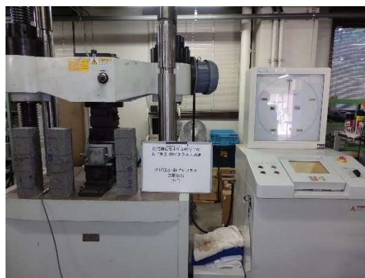
写真-4 曲げ強度・曲げタフネス試験状況
